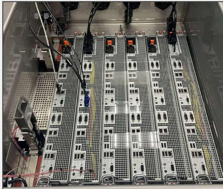
12U 15KW 浸沒式水冷槽
